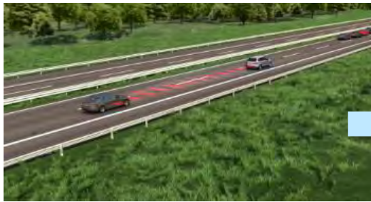
センサシステムは車両が移動中での接近を検知
