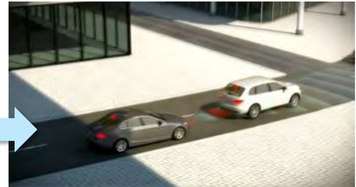
3. ADASがESPにフルブレーキング指示
